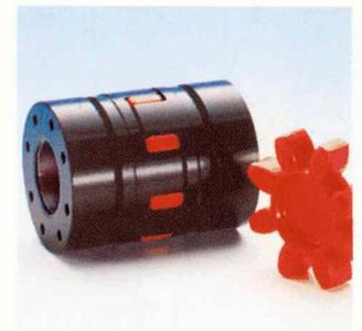
Spielfreie Drehmomentübertragung auf Grund von vorgespannten Zahnkränzen. Steifigkeit und Dämpfungsverhalten können mittels der Härte von diesen Teilen variiert werden.
